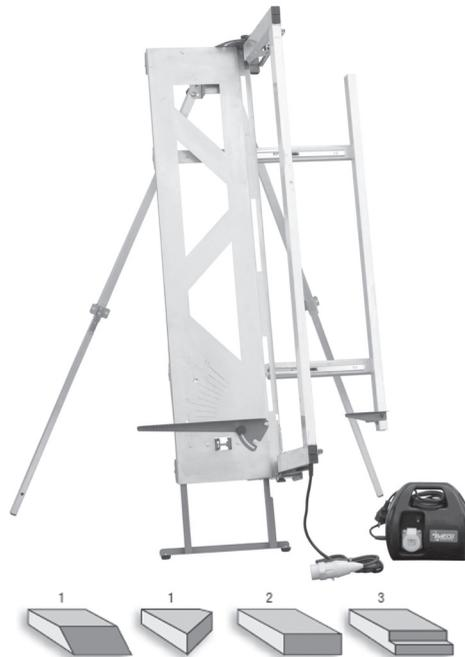
**Figura 9.15** - Banco con taglierina a filo caldo per pannelli isolanti. Diverse tipologie di taglio: 1) taglio ad angolo (su tutti i lati); 2) taglio dritto; 3) taglio a gradino
